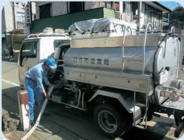
消火栓から給水車への充水の様子(太子町にて)
