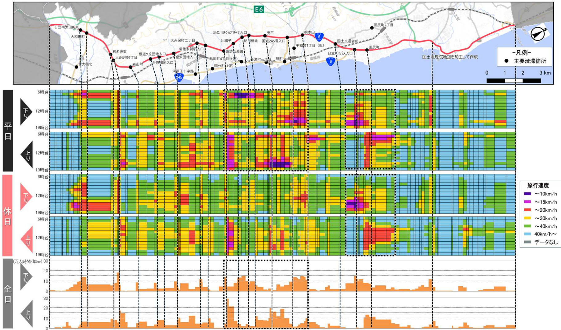
国道6号軸の速度コンター図と渋滞損失時間
