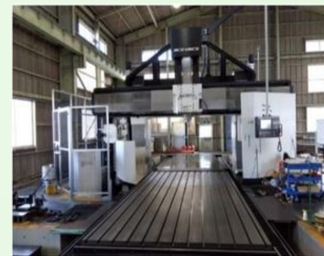
省力化補助金を活用して導入した5面加工機
