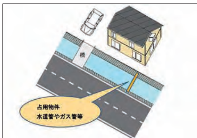
河川の占用物件等の状況
