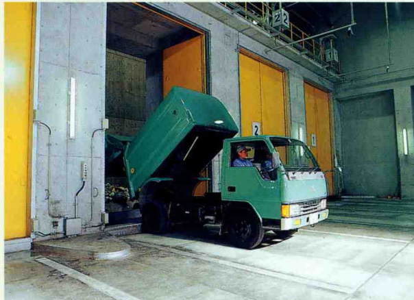
①プラットフォーム 搬入されたごみは、ここらごみピットへ投入されます。搬入車は、コンピュータにより投入扉まで誘導されます。
