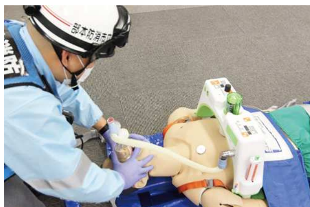
人工呼吸も行うことができ、一つの機器で一連の心肺蘇生法を実現し、救命率の向上を目指します
