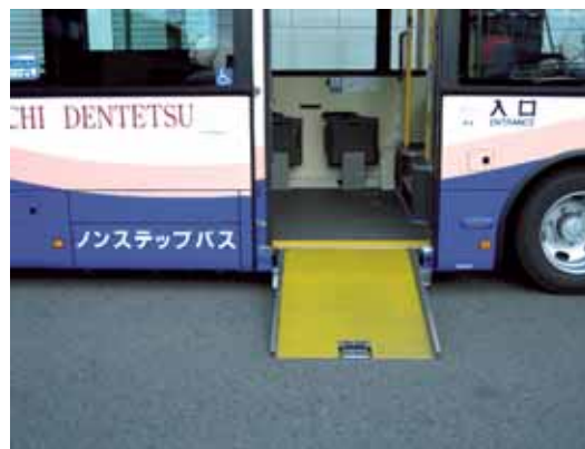
車高調整機能により、エアサスペンションの空気を抜くことで車両を乗降口側に傾け、スロープを延ばしたところ
