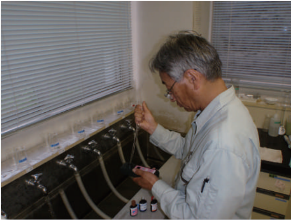
水質検査(残留塩素測定・金属分析)
