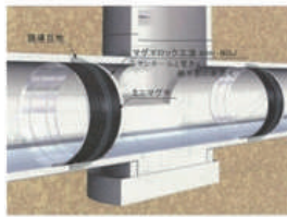
管口可とう化(マグマロック工法の例)
